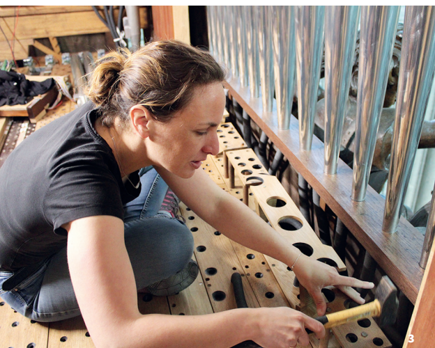
3 - D'un autre côté, sont fixés les faux-sommiers qui permettront de stabiliser les tuyaux sur le sommier du grand orgue, juste à l'arrière de la plate face centrale.
