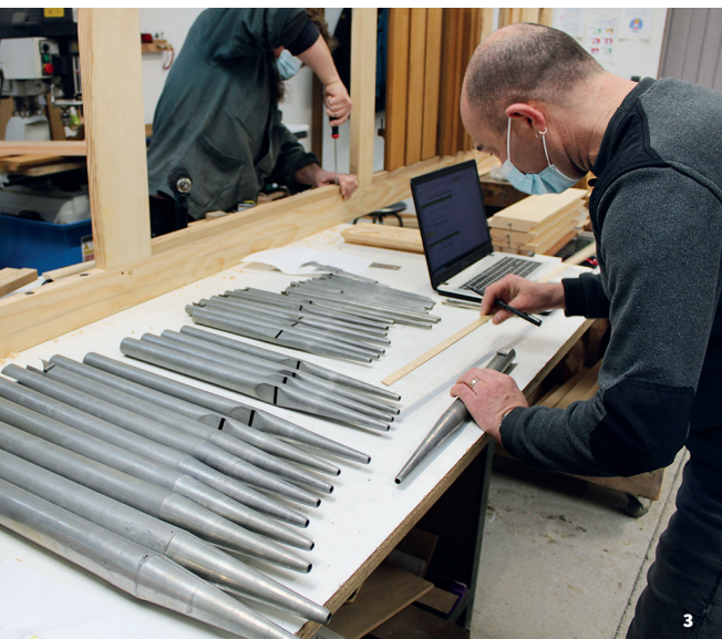
3 - Pendant ce temps, dans son atelier, le facteur d'orgue entreprend la réharmonisation des séries de tuyaux provenant de la basilique.
