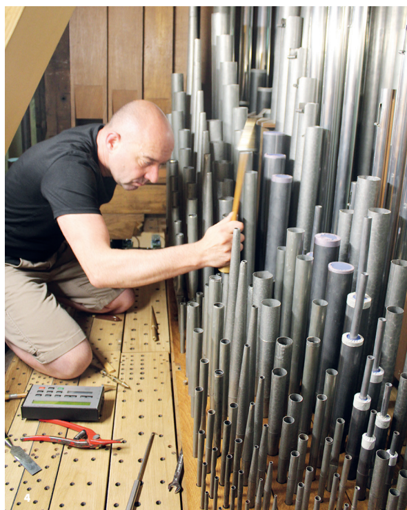
4 - Les séries de tuyaux provenant de l'atelier viennent progressivement peupler les sommiers et doivent être accordés au fur et à mesure de leur installation.
